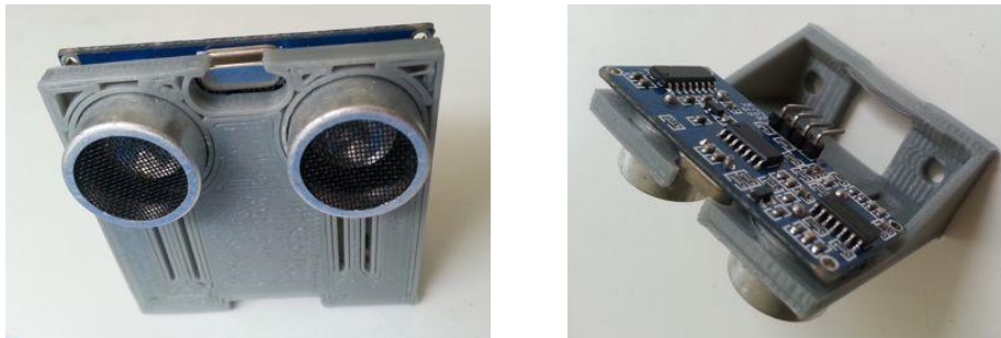
Figura 3. Sensor electrónico que se coloca a la altura y posición de acuerdo a los requisitos de diseño gracias a la pieza impresa en 3D.
