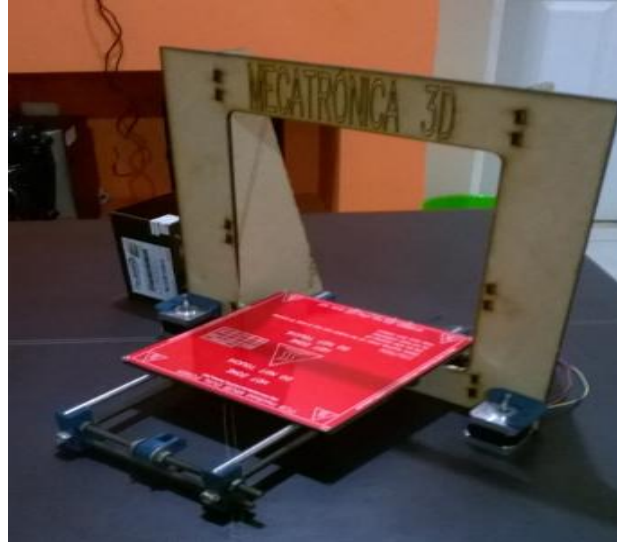
Figura 3. Estructura preliminar de Impresora 3D
