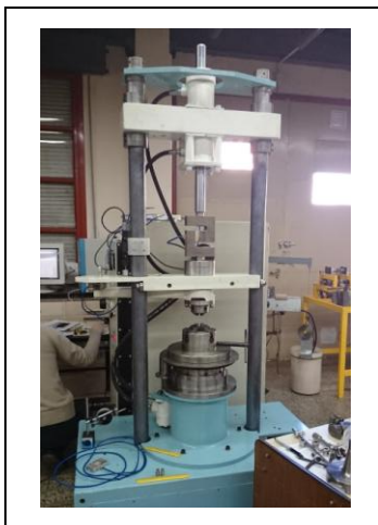
Figura 3. Máquina tribológica para ensayos de desgaste adhesivo para configuración copa cono.
