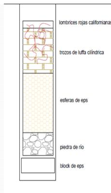
Figura 2. Acomodo de soportes filtrantes en el lombrifiltro.
