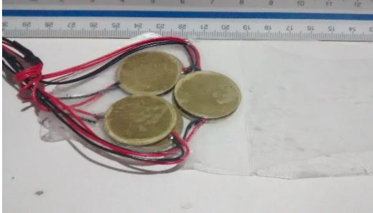
Figura 5. Conexión física de los elementos piezoeléctricos
